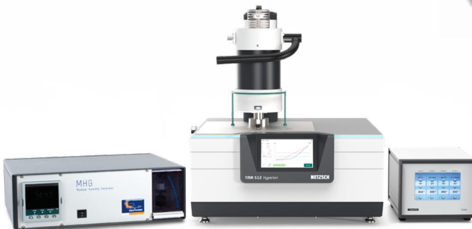
Feuchtgenerator, angeschlossen an die TMA 512 Hyperion ®
