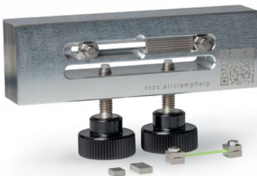
Vorrichtung Probenvorbereitung für Messungen im Zugmodus
