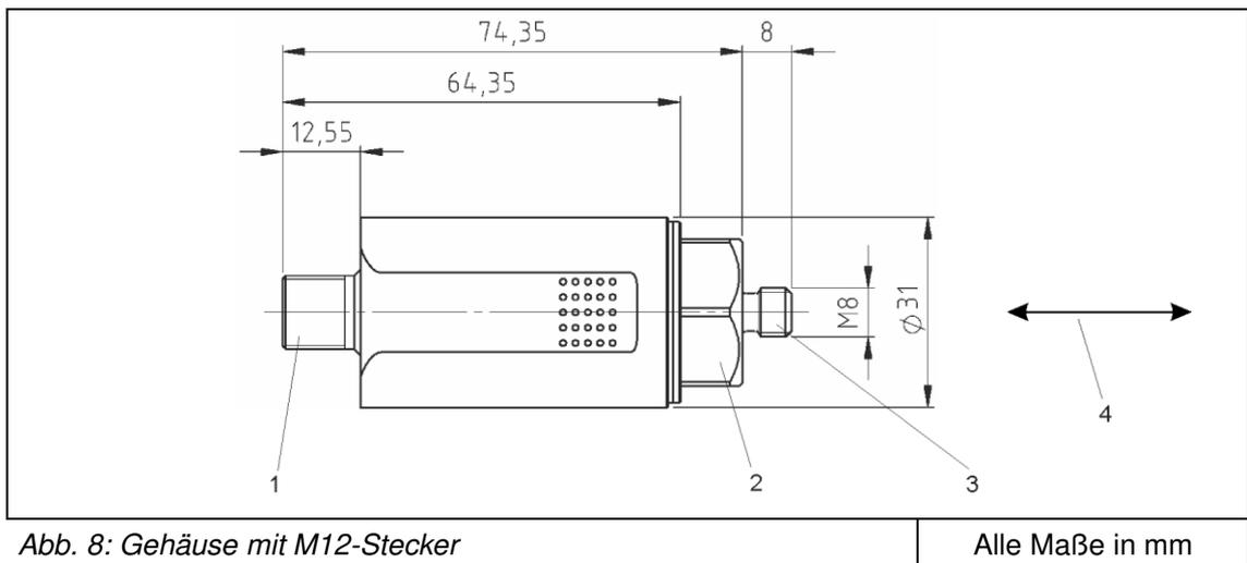
Abb. 8: Gehäuse mit M12-Stecker
