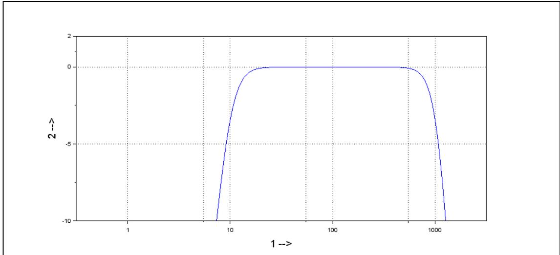
Abb. 6: Typischer Frequenzgang 10 Hz bis 1000 Hz
