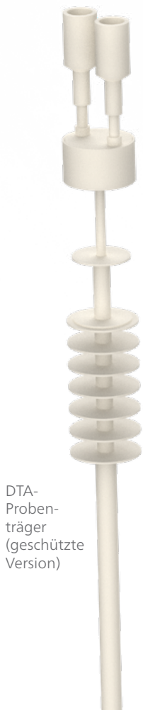
DTA- Proben- träger für Tempera- turen bis 2000 °C
